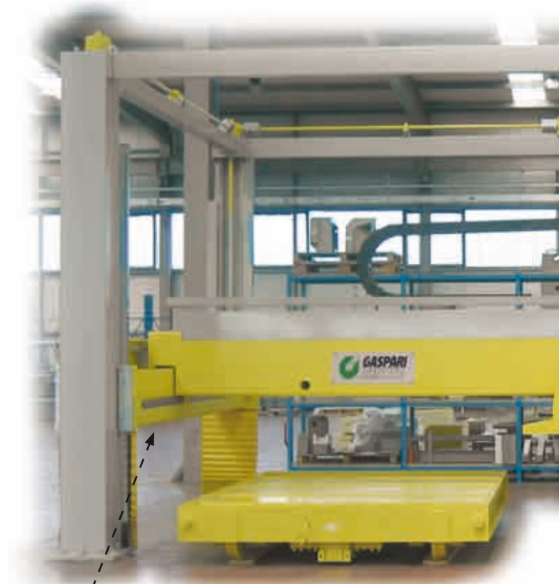
Particolare del carro portamandrino in fase di taglio combinato (verticale e orizzontale). La freccia indica la direzione di taglio.
