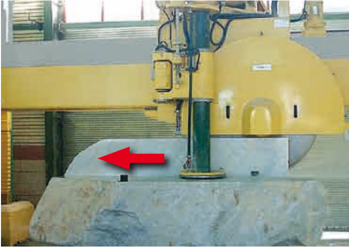
Particolare del carro portamandrino in fase di taglio combinato (verticale e orizzontale). La freccia indica la direzione di taglio.
