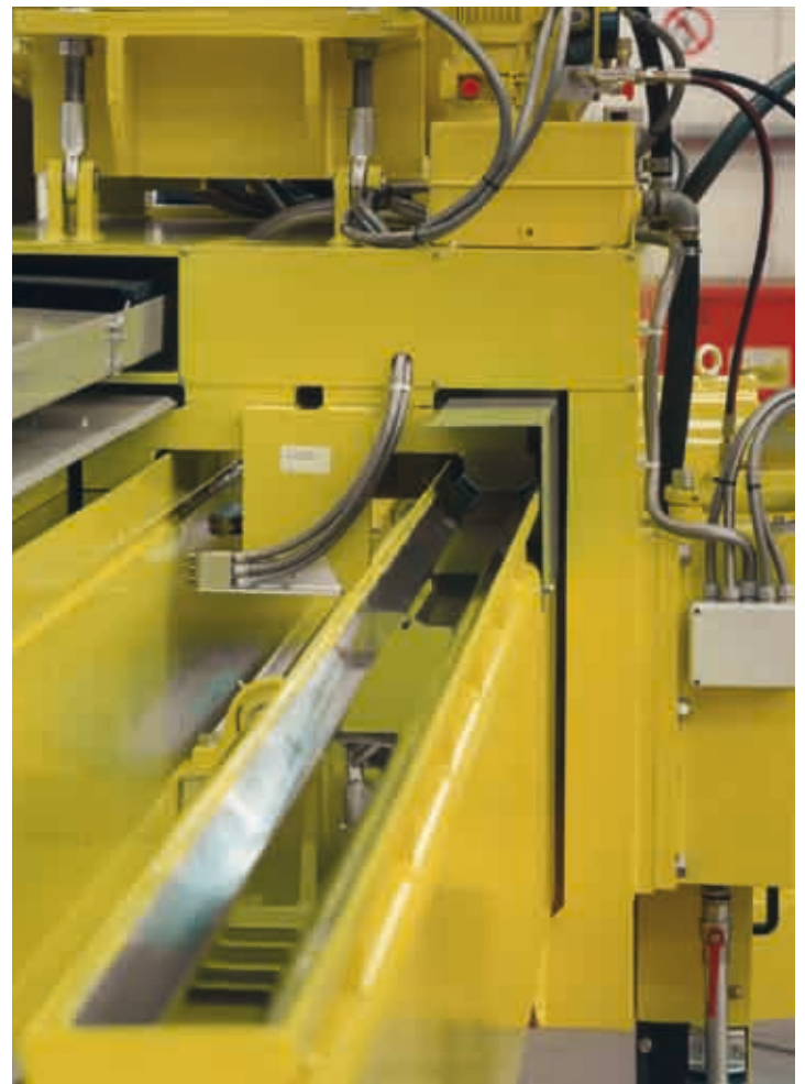
Dettaglio del carro portamandrino e suo scorrimento sul ponte / Detail of the spindle holding carriage and its sliding on the beam
