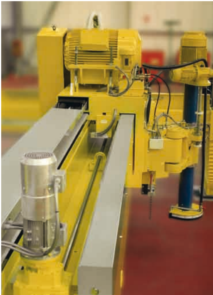
Dettaglio del carro portamandrino e suo scorrimento sul ponte / Detail of the spindle holding carriage and its sliding on the beam
