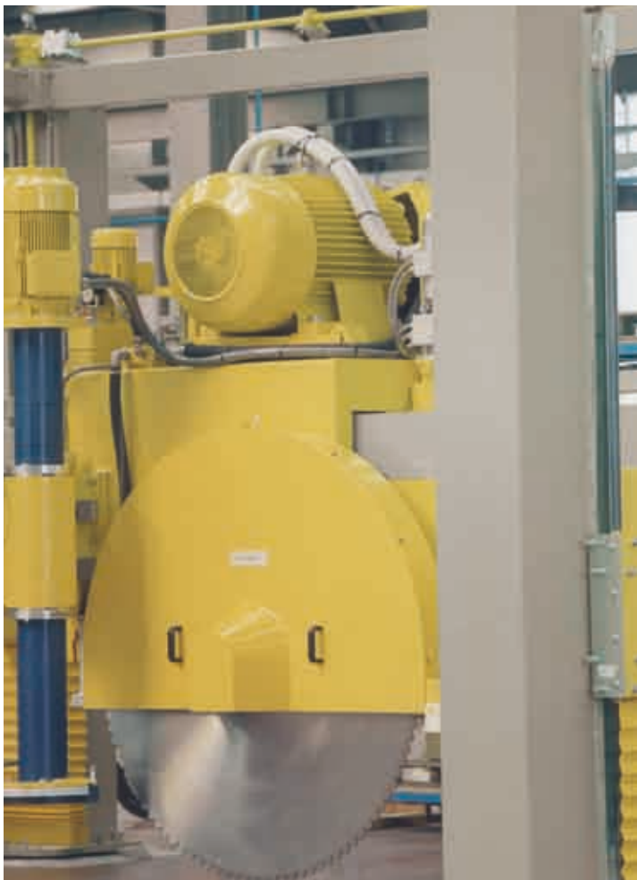
Dettaglio del carro portamandrino e suo scorrimento sul ponte / Detail of the spindle holding carriage and its sliding on the beam
