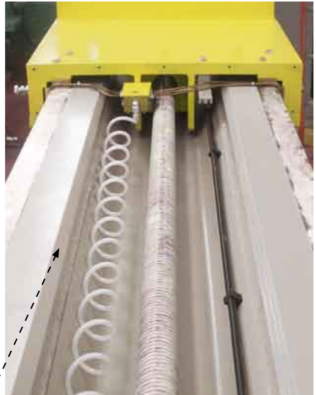
Due viste del cursore, vite e sua lubrificazione. Two views of the slider, main screw and its lubrication system. Deux vues du curseur, la grosse vis et sa lubrification.
