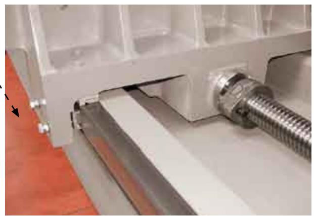
Due viste del cursore, vite e sua lubrificazione. Two views of the slider, main screw and its lubrication system. Deux vues du curseur, la grosse vis et sa lubrification.
